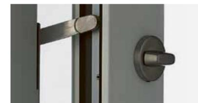
Die **Türsperre TSH** dient als Öffnungsbegrenzung. Sie wird außen über das Hauptschloss betätigt (kein Zylinder außen). Die Betätigung innen erfolgt über einen Drehknopf.
